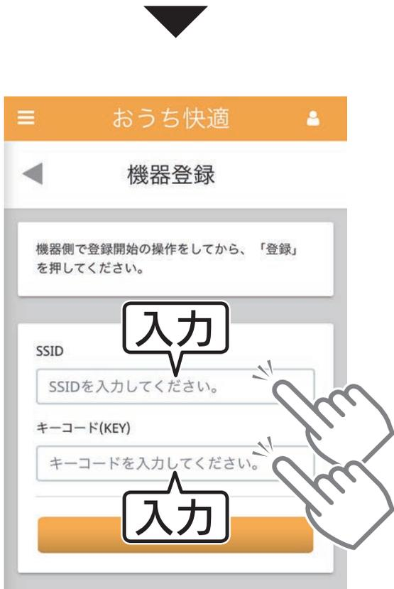
⑦「SSID」「キーコード(KEY)」の欄をタップして無線アダプター背面に貼っているシール、または無線アダプターセット付属の「SSID/KEYシール」に記載の「SSID」「KEY」を入力する
