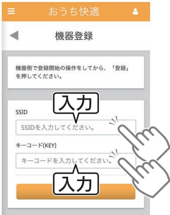
⑪「SSID」「キーコード(KEY)」の欄をタップして⑥で確認した「SSID」「キーコード」を入力する
