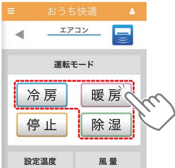
② 運転したい運転モードのスイッチ(冷房 暖房 除湿)をタップする
