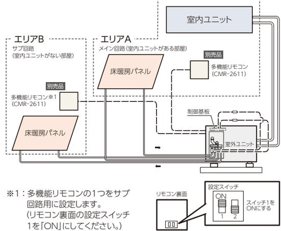
**施工プラン B** 床暖房3回路3制御の場合／AEYH-0646BFXの設置例
