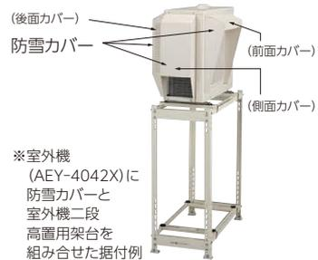
※室外機(AEY-4042X)に防雪カバーと室外機二段高置用架台を組み合わせた据付例
