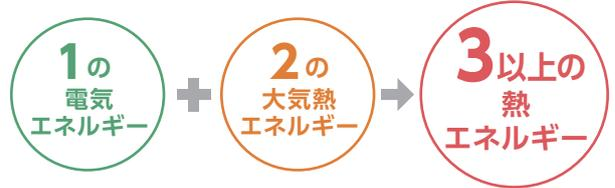
エコキュートは『1』の電気エネルギーを使い『2』の大気熱エネルギーをくみ上げ、『3』以上の熱エネルギーを生み出し、お湯を沸かします。
