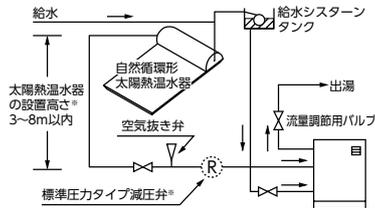
※太陽熱温水器と機器の落差は3m以上8m以下にしてください。機器への給水圧が0.08MPa(0.8kgf/cm<sup>2</sup>)を超える太陽熱温水器(直圧式太陽熱温水器や8mを超える高さに取り付けられた場合は、減圧弁(P107参照)を途中に入れて機器に接続してください。)
