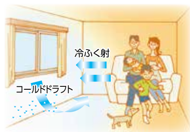
■ 窓表面の温度が下がって結露ができます
