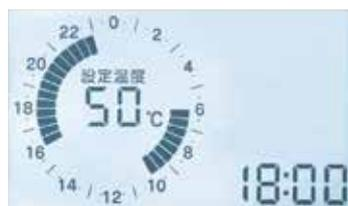
「タイマー(予約)運転」をセットすると、毎日設定した運転パターン(運転/停止)を繰り返します。1日で2つの時間帯(午前・午後等)で運転の設定をするだけなので、操作がシンプルで使いやすくなっています。
