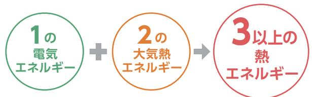
エコキュートは『1』の電気エネルギーを使い『2』の大気熱エネルギーをくみ上げ、『3』以上の熱エネルギーを生み出し、お湯を沸かします。
