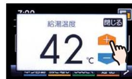
「給湯温度表示」をタッチ、**+** **-** をタッチし温度を変更します
