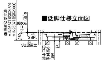
※SBFLから脱衣所FLの高さ寸法(本図は(注)9[中折ドアの場合])は、ドアにより異なりますので、ドア寸法図(P138)を参照してください。
