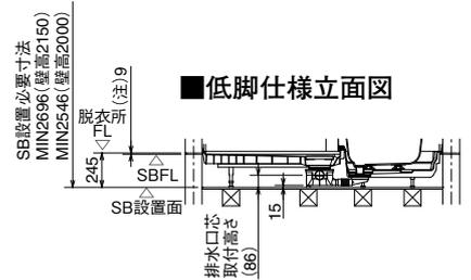
【※A】各部材のSB設置必要寸法からのはり出し寸法(上図で設置した場合)
