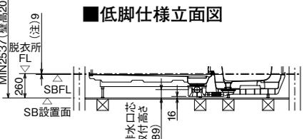
※SBFLから脱衣所FLの高さ寸法(本図は(注)9[中折ドアの場合])は、ドアにより異なりますので、ドア寸法図(P138)を参照してください。
