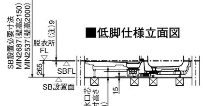
※SBFLから脱衣所FLの高さ寸法(本図は(注)9[中折ドアの場合])は、ドアにより異なりますので、ドア寸法図(P138)を参照してください。
